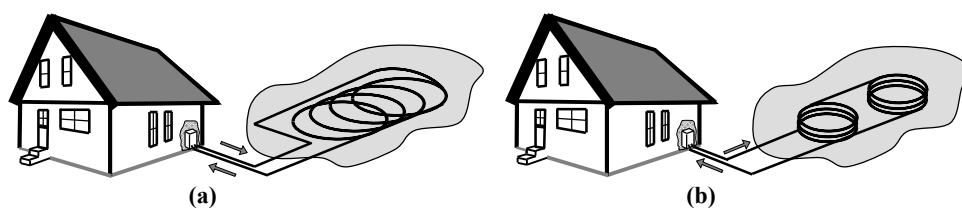
Fig. 6.2.63 Colector geotermal dispus în buclă imersată
