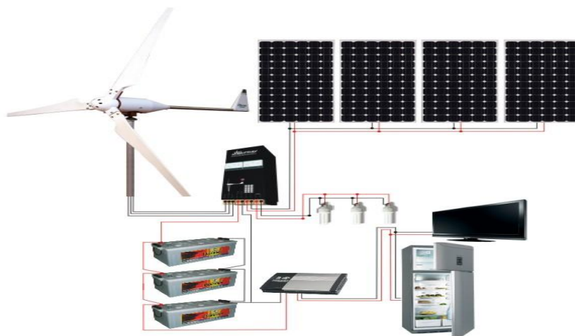
Fig. 6.2.62 Principale componente ale sistemelor hibride
