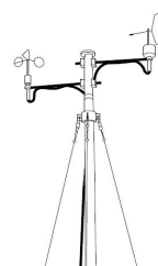
Fig. 6.2.27. Stâlp de măsurare a direcției și vitezei vântului
